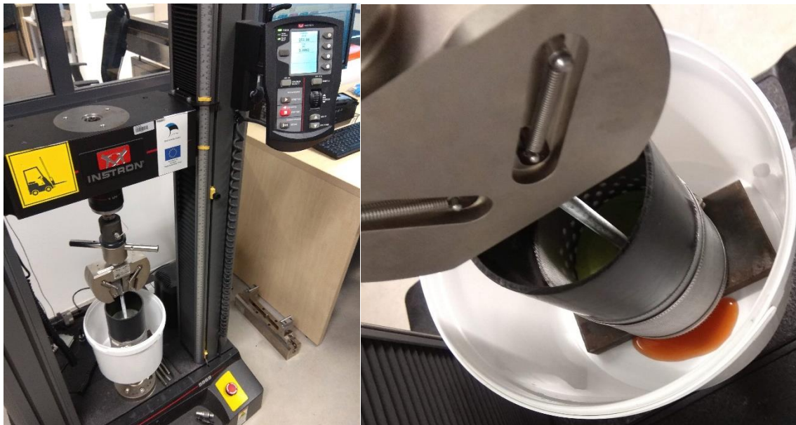
Joonis 2.1. Mahla pressimise katse.
