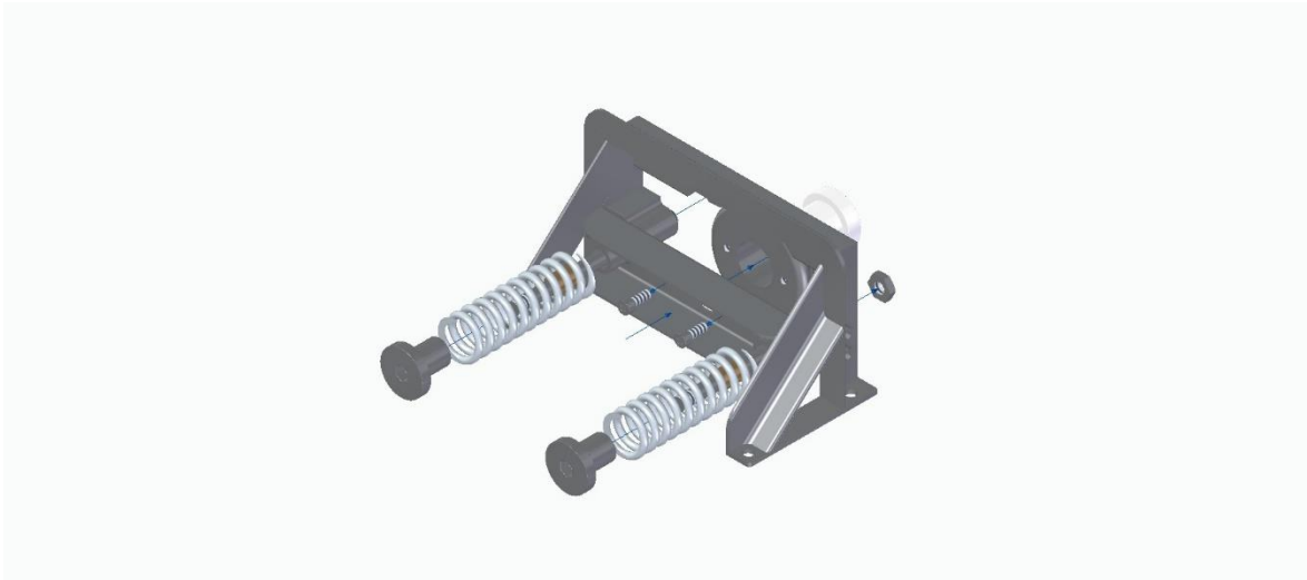
Joonis 3.4. Otsaklapi mehhanismi hajutatud vaade.
