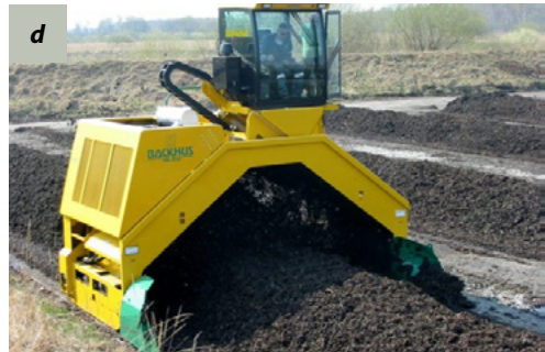
Joonis 4. Kompostiauna segamine: a – eestlaaduriga, b – kopp-purustiga ALLU, c – järelveetava pööriliga COMPOST and WASTE Technology ST-300, d – liikurpööriliga BACKHUS
