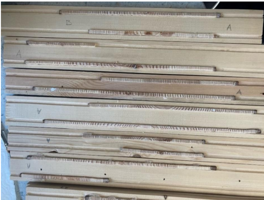
Joonis 4. Lihvitud ja liimitud puursüdamikud. (autori foto)
