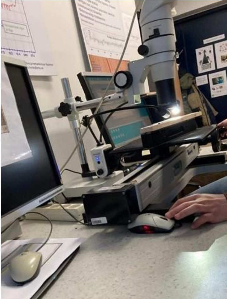
Joonis 5. Mikroskoobiga mäni puursüdamike mõõtmine. (autori foto)
