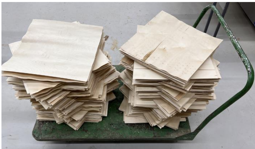
Joonis 18. Sorteeritud spoonilehed laotati seitsmekihiliseks spoonipaketiks.
