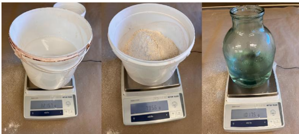
Joonis 19. Liimaine komponentide kaalumine vastavalt liimitootja retseptile (liimvaik + kõvendi + vesi).
