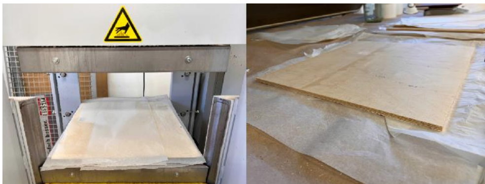
Joonis 24. Vineeritoorikute kuumpressimine.
