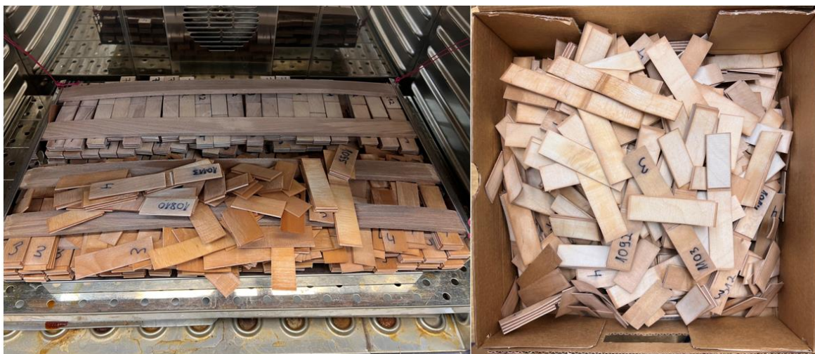
Joonis 39. UF katsegruppi kuuluvad katsekehad.
