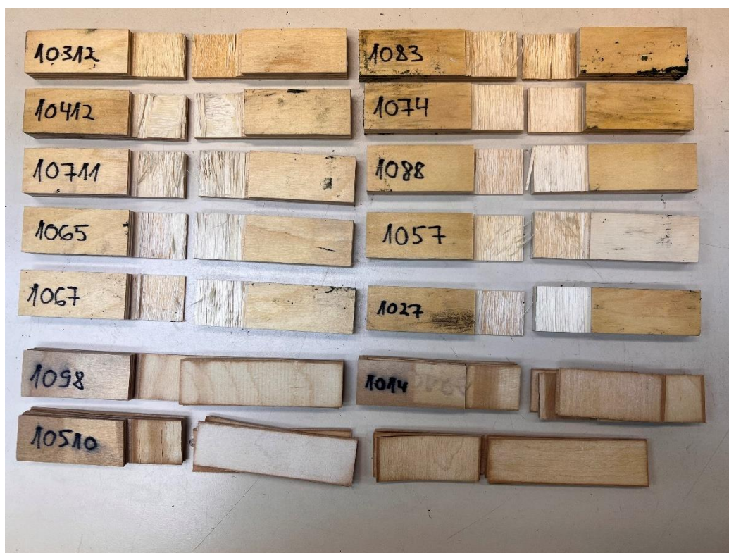
Lisa 4.1. UF liimi näiv puidust purunemine jahedal ja kuumal eeltötlusel.
