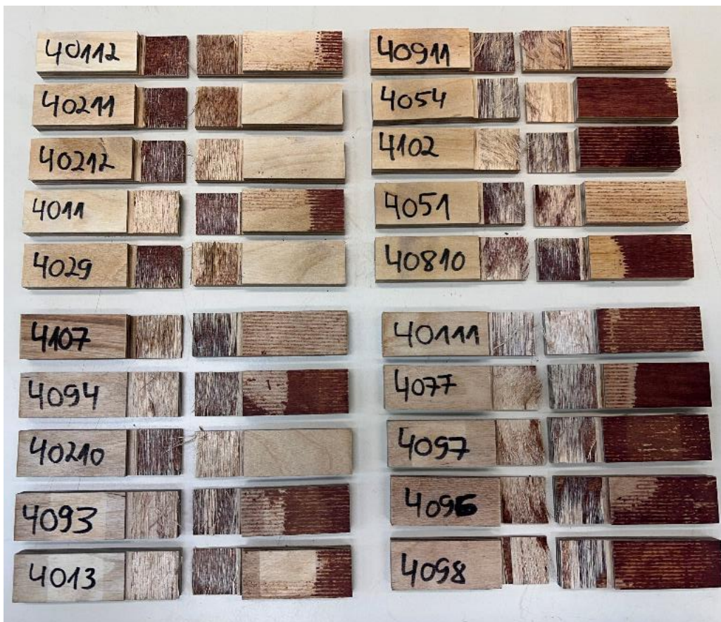
Lisa 4.4. PF liimi näiv puidust purunemine jahedal ja kuumal eeltötlusel.
