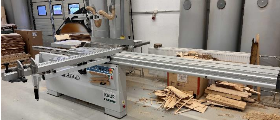
Joonis 8. Formaatsaag Griggio SC32.
