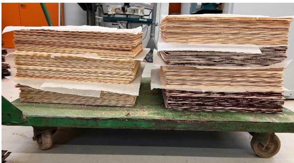
Joonis 25. Vineeriplaadid. Kokku 70 plaati ehk iga liimi kohta 10 plaati.
