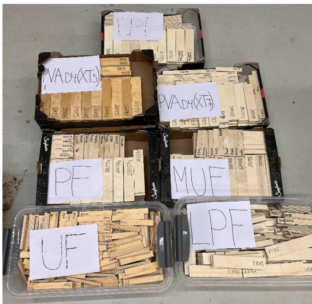
Joonis 28. Katsekehad. Kokku 1680 tükki.
