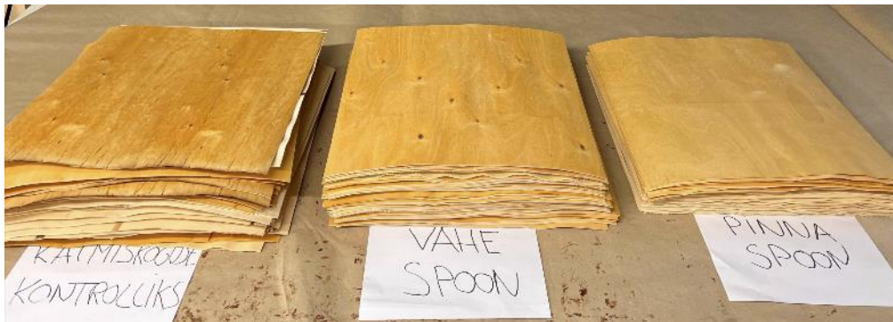
Joonis 17. Spoonilehed sorteeriti kolme gruppi – katmiskoguse kontrolliks, vahespoon, pinnaspoon.
