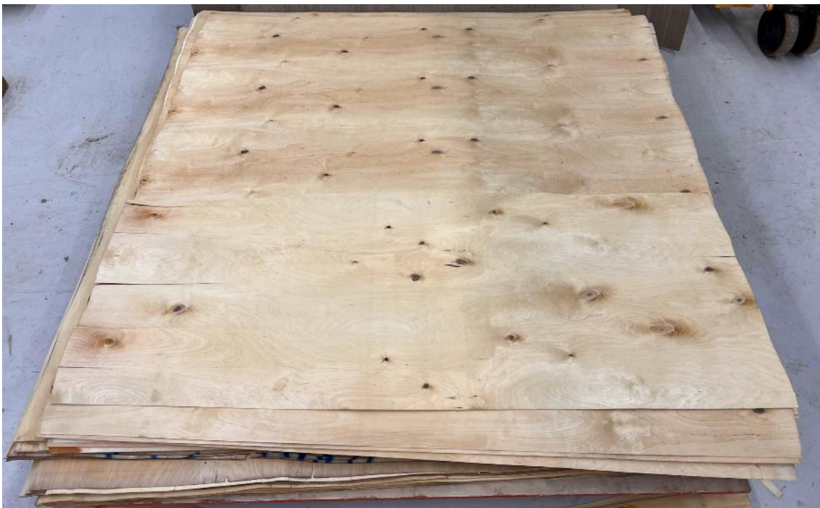
Joonis 6. K2 ja K3 kvaliteediga spoon, mõõtudega 1595 mm x 1595 mm.
