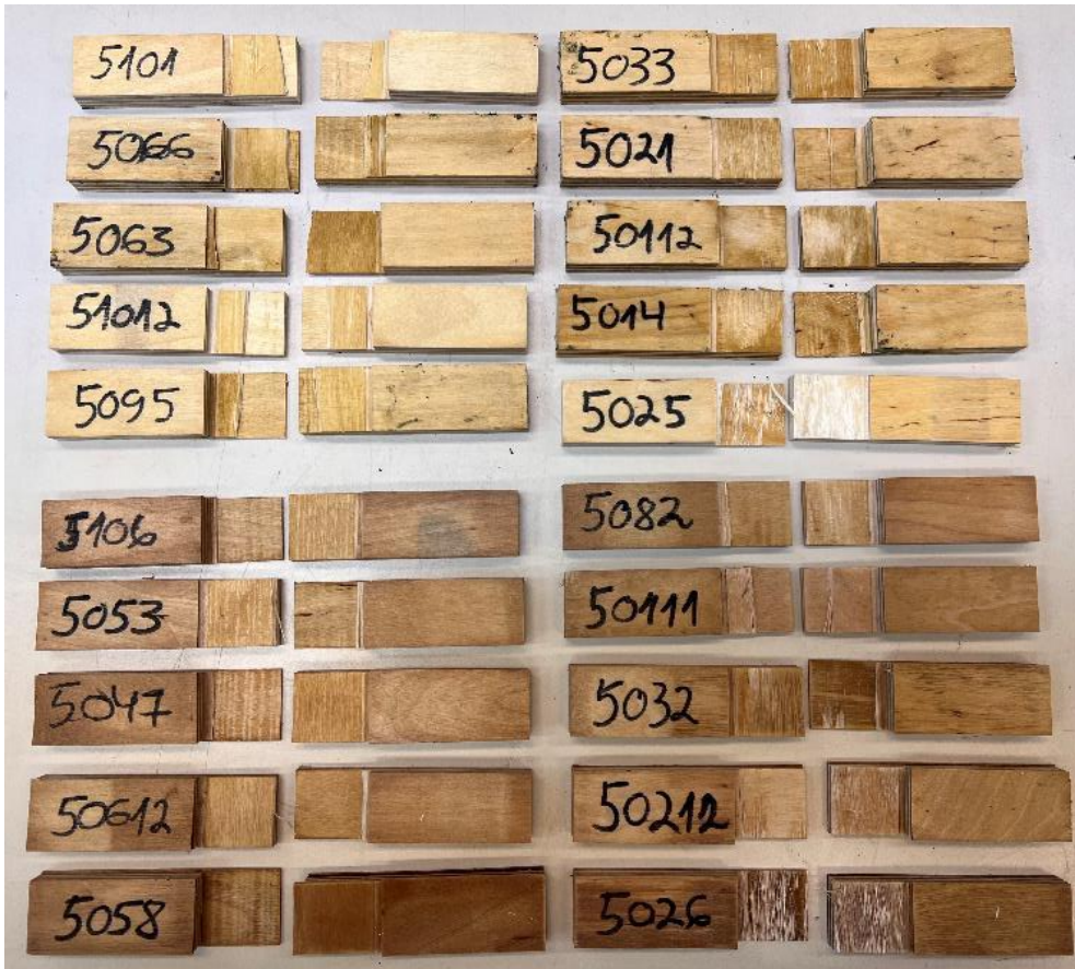
Lisa 4.5. PVAc XT5 liimi näiv puidust purunemine jahedal ja kuumal eeltöötlusel.
