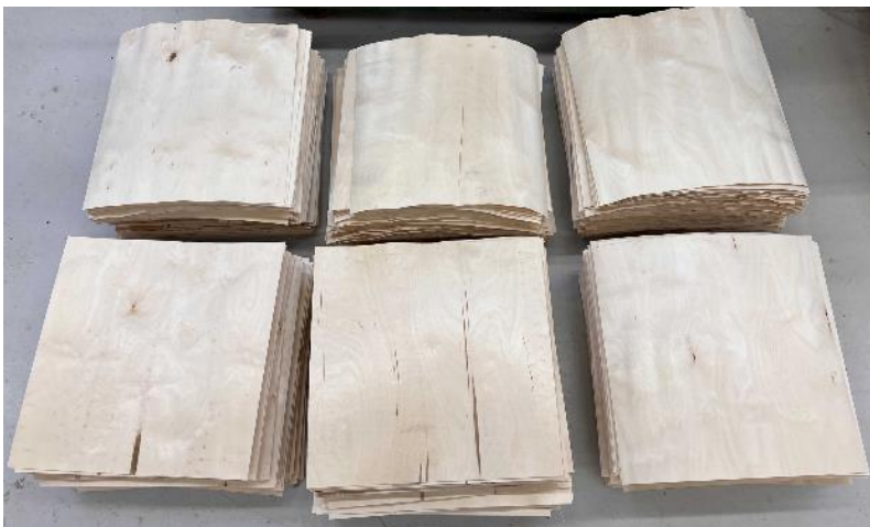
Joonis 16. 500 x 500mm tükkideks lõigatud spoon.
