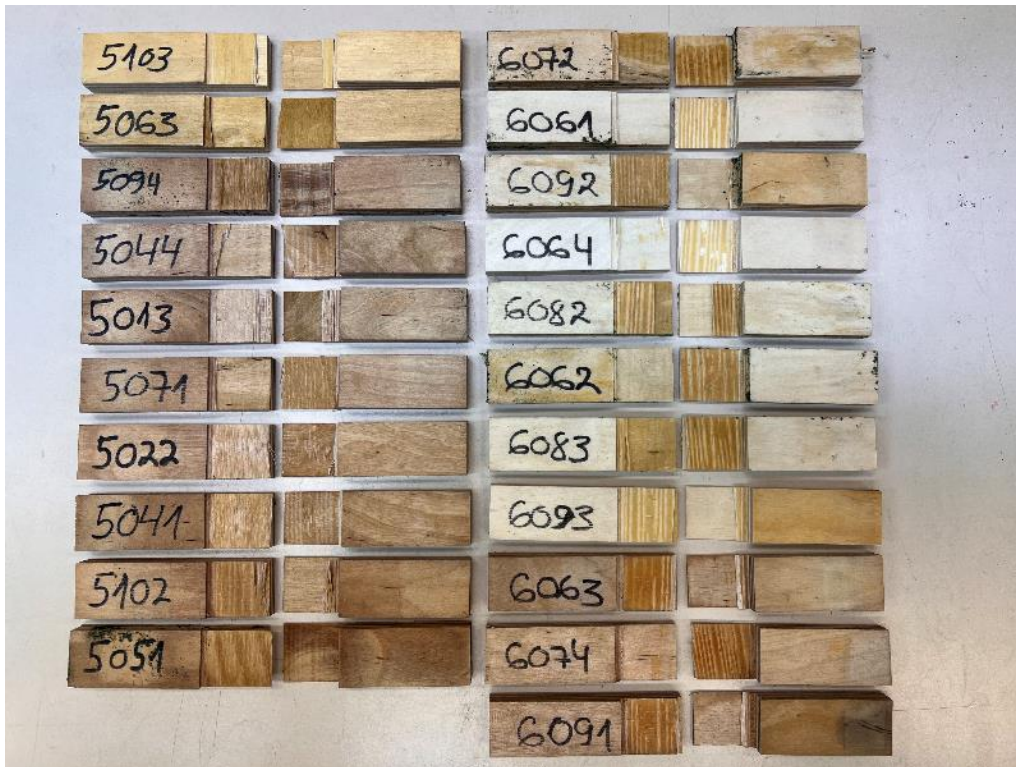
Lisa 3.1. Näiv puidust purunemine esimeses spoonikihis katsekehadel nihketugevus väärtusega < 1 \text{ N/mm}^2 .
