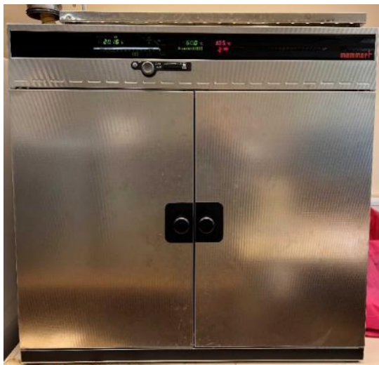
Joonis 14. Memmert ULE 600 kuivatuskapp.
