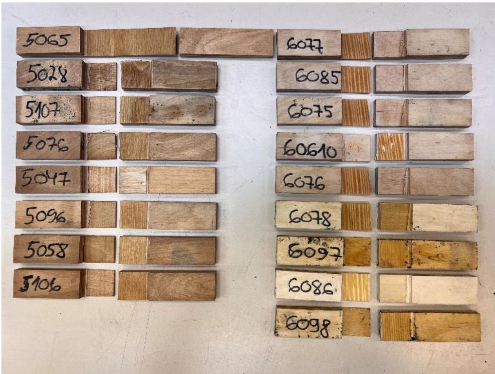
Lisa 3.3. Näiv puidust purunemine kolmandas spoonikihis katsekehadel nihketugevus väärtusega < 1 \text{ N/mm}^2 .
