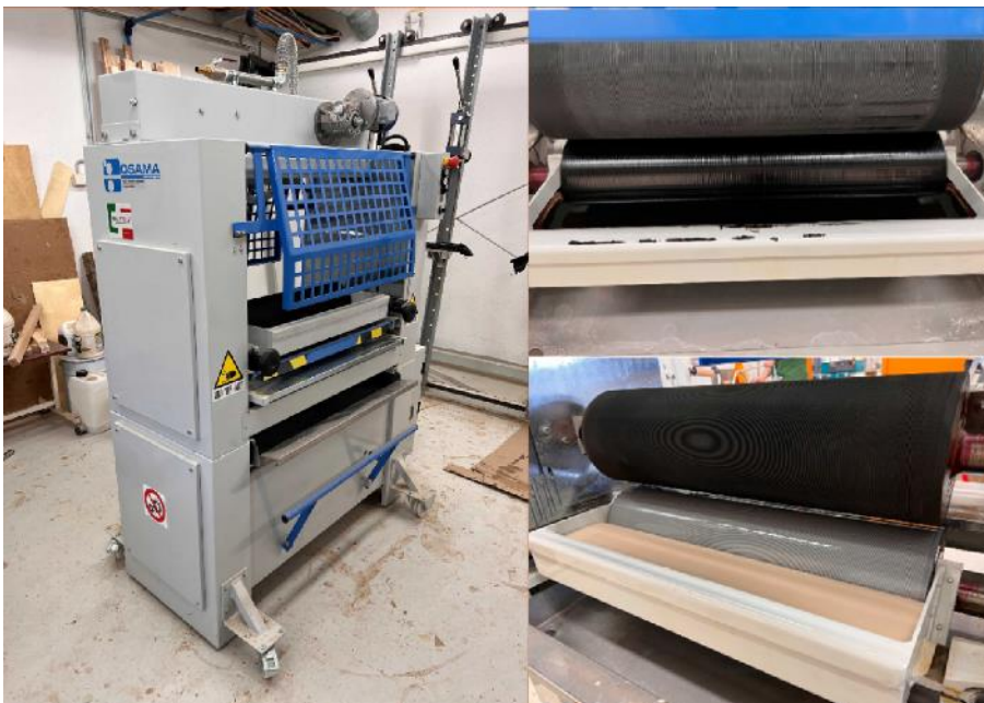
Joonis 9. Osama S2R-600 liimimismasin.
