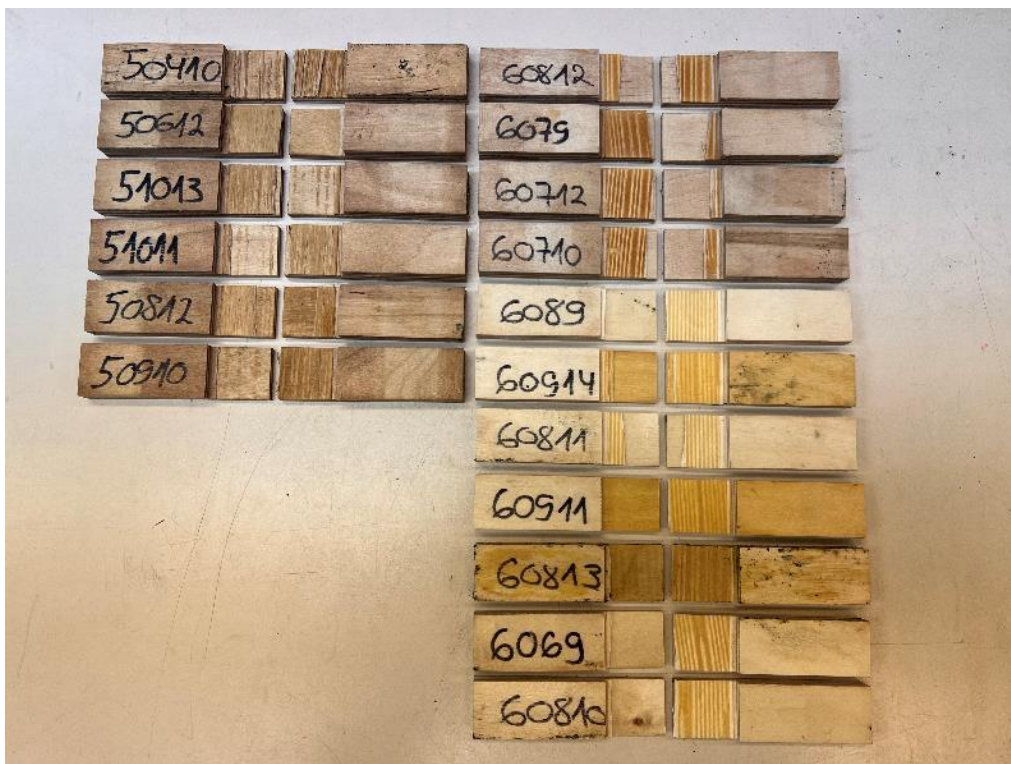
Lisa 3.2. Näiv puidust purunemine teises spoonikihis katsekehadel nihketugevus väärtusega < 1 \text{ N/mm}^2 .
