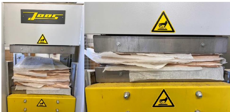
Joonis 23. Spoonipakettide eelpressimine ehk külmpressimine laborpressiga Joos Lap 60.
