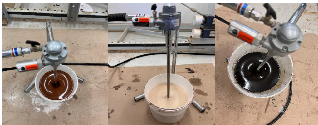
Joonis 20. Fenoolliidide mikserdamine – PF (punakaspruun), MUF (valkjask/beež), LPF (mustjas).
