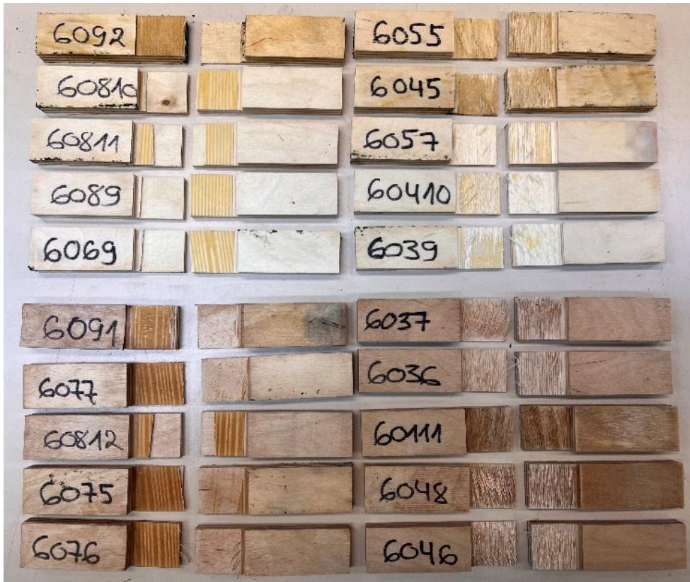
Lisa 4.6. PVAc XT7 liimi näiv puidust purunemine jahedal ja kuumal eeltöötlusel.
