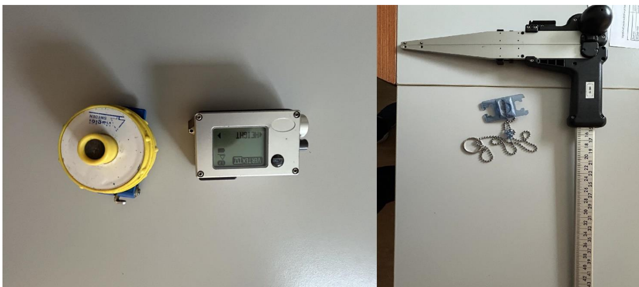
Joonis 2. Töös kasutatud mõõtevahendid: kõrgusmõõtja Vertex IV, Bitterlichi lihtrelaskoop ja metsaklupe.
