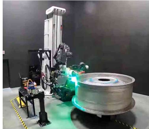
Joonis 11. 3D prinditav detail, alustati järgmise seina printimisega.[14]
