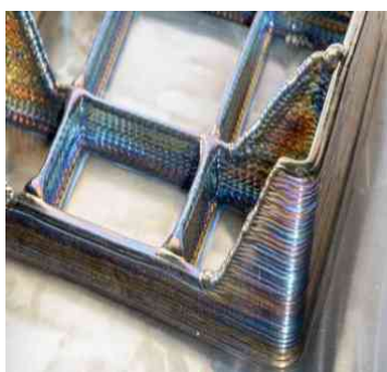
Joonis 8. Traatkeevitusega 3D prinditud detail [12]
