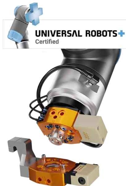
Joonis 14. Kiirvahetussüsteem roboti UR3 küljes.
