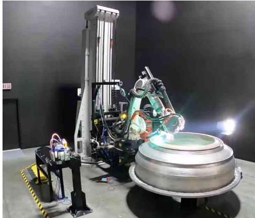
Joonis 10. 3D prinditav raketiosa.[14]
