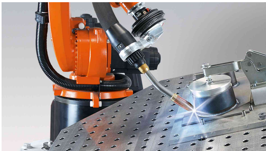
Joonis 7. Kuka robot keevitamas detaili
