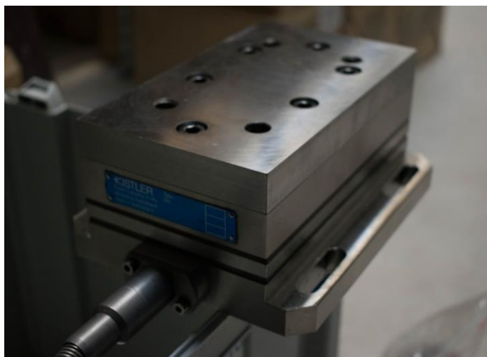
Joonis 9. Lõikejõudude mõõtmiseks mõeldud dünamomeeter Kistler 9257B [erakogu]
