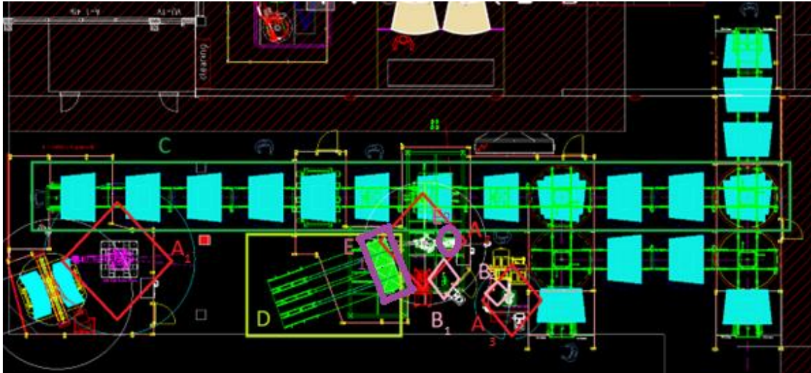
Joonis 1.3. SC2 tootmisliin ülevaade A 1 -klaasi tõstmis robot, A 2-3 - manusliimimisrobot, B 1-2 - liimi düüs, C- klaasi konveier, D- manuse konveier, E 1 - manusekaamera, E 2 - liimikaamera.
