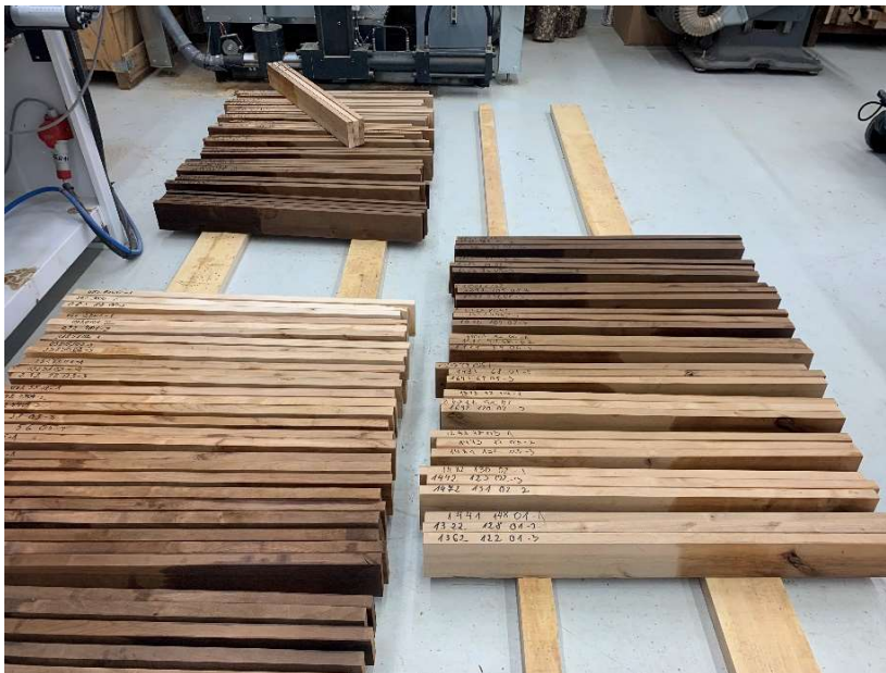
Joonis 4. Liikide ja töötlusastmete kaupa sorteeritud katsekehad.
