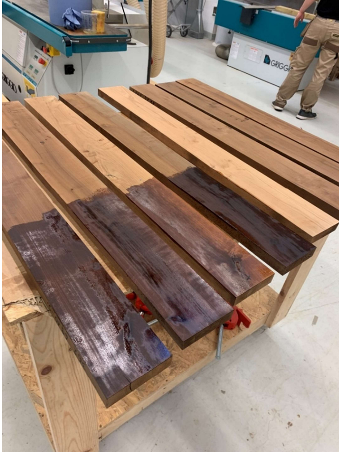
Joonis 3. Katsekehade õlitamine.
