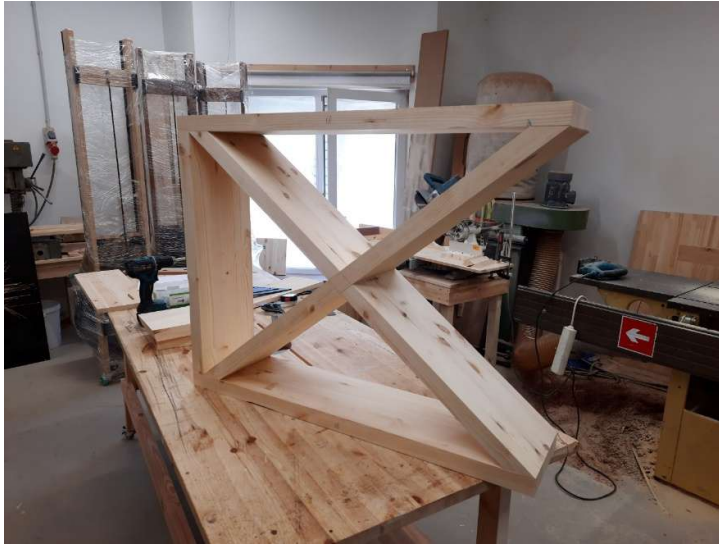
Joonis 1. Jalgade konstruktsiooni proovitükk männist
