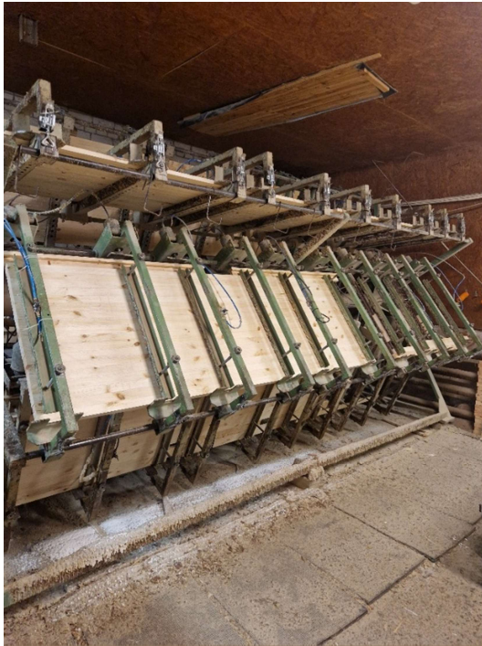
Joonis 4. Töös kasutatud külmpress lamellide kokku liimimiseks
