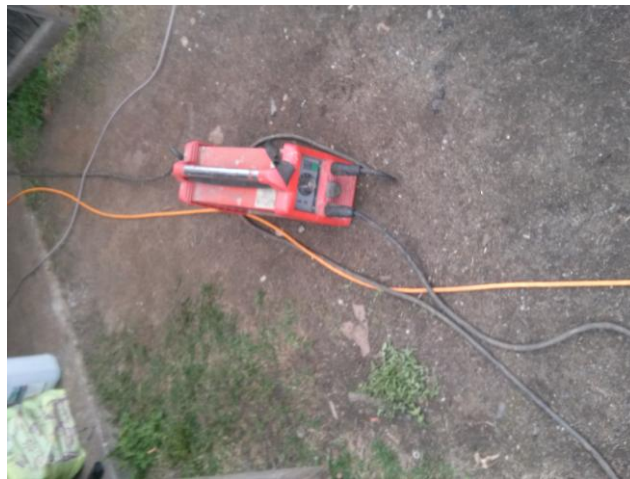
Joonis 13. keevitusaparaat Transpocket 2500 RC
