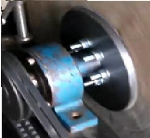
Joonis 7. Flantse läbivad poldid koos nylock mutritega
