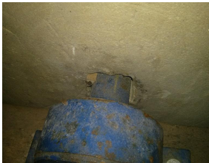
Joonis 24. Võll fikseeritud puust kiiludega
