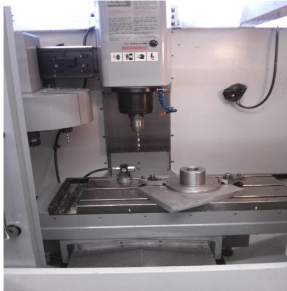
Joonis 21. Flantsi puurimine CNC masinaga mini mill
