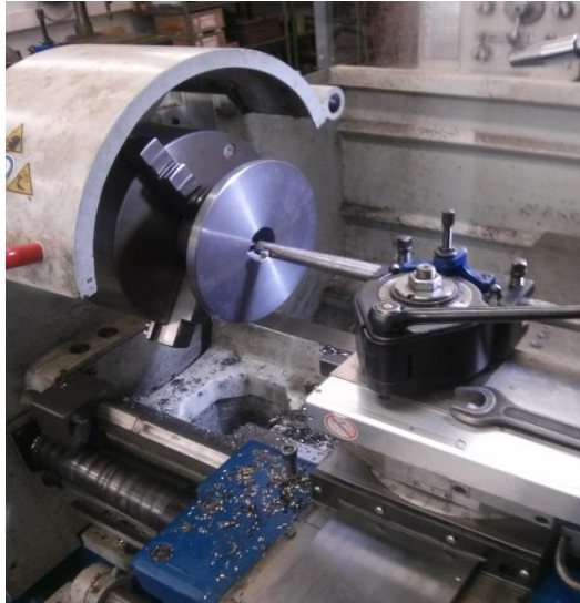
Joonis 17. Kiilusoone tegemine
