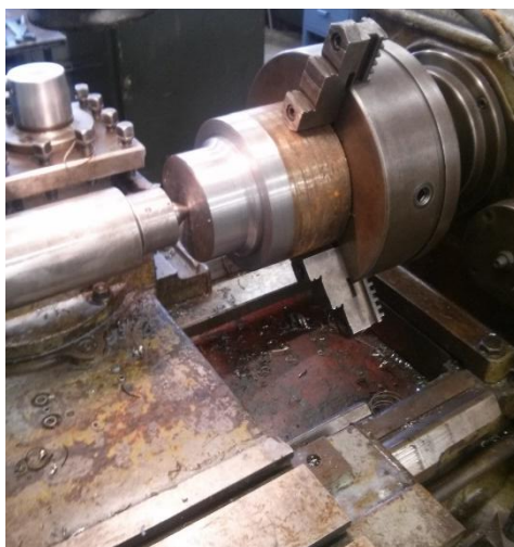
Joonis 16. Treimine masinaga IK62
