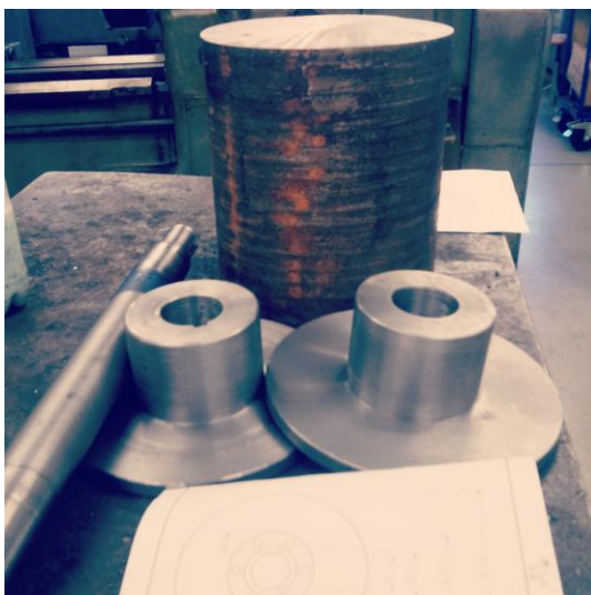
Joonis 8. Pooleks lõigatud ümarraud koos valmis flantsidega.
