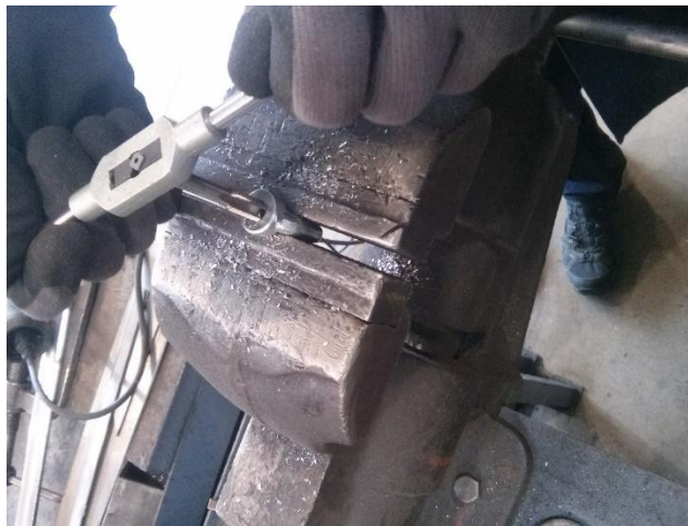
Joonis 20. Tõstesilmuse keermestamine
