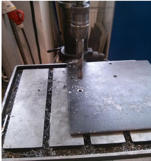
Joonis 22. Rihmapingutusmehhanismi ja mootori kinnitus aukude puurimine
