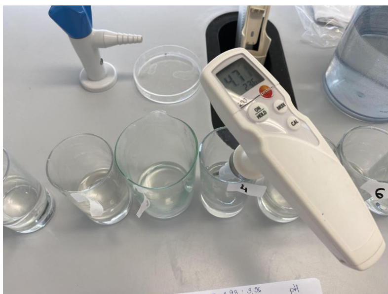
Joonis 18. pH mõõtmine pH-meetriga Testo 205 (foto: Lisann Rebane).
