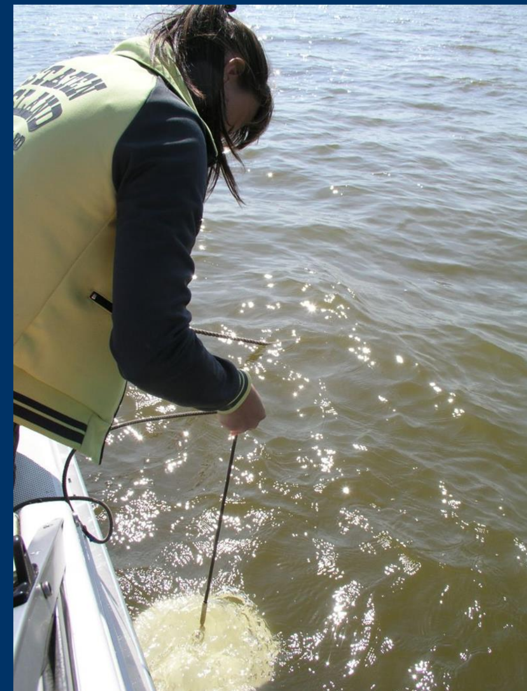
Foto: Lea Tuvikene Vee läbipaistvuse mõõtmine Secchi kettaga (valge metallkett, mis lastakse sügavusmärkidega nõõri otsas vette kuni seda silmaga näha pole ja registreeritakse sügavus, mil ta üles tõstes uuesti nähtav on).
