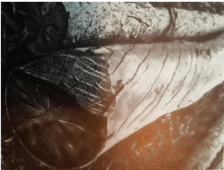
Joonis 4. Tangetsiaalne kalldkiulisus kuusepalgil (foto: erakogu).
