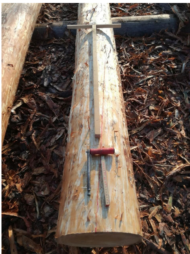
Joonis 8. Mõõtmisraud, mõõtelatt ja mõõtmispulk (foto: erakogu).
