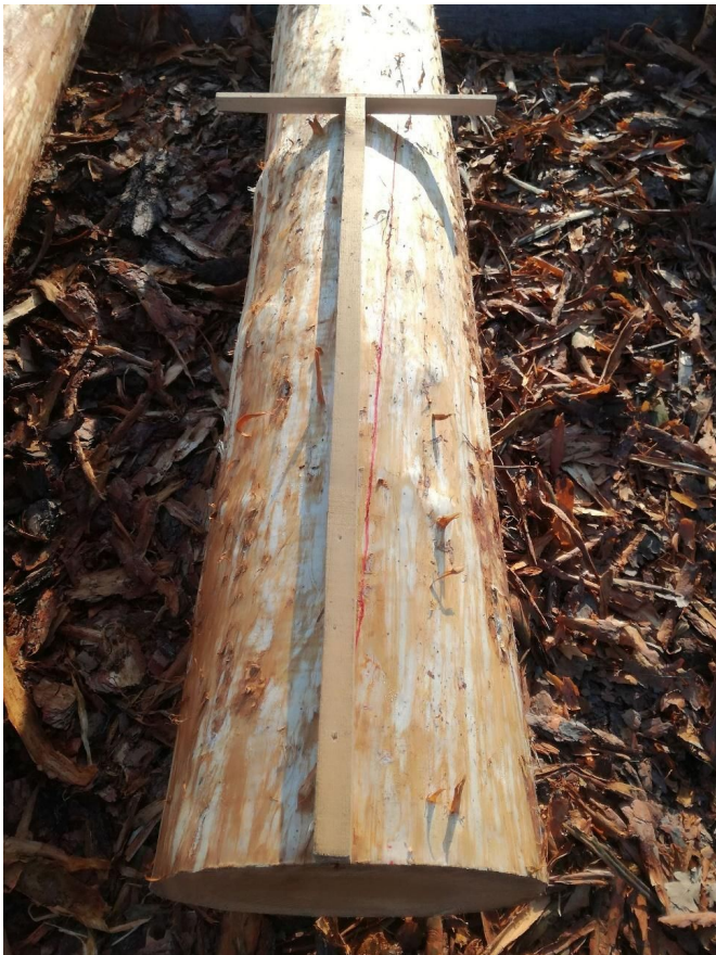
Joonis 10. Kooritud männipalgi kaldkiulususe mõõdistamine mõõtrauga (erakogu).
