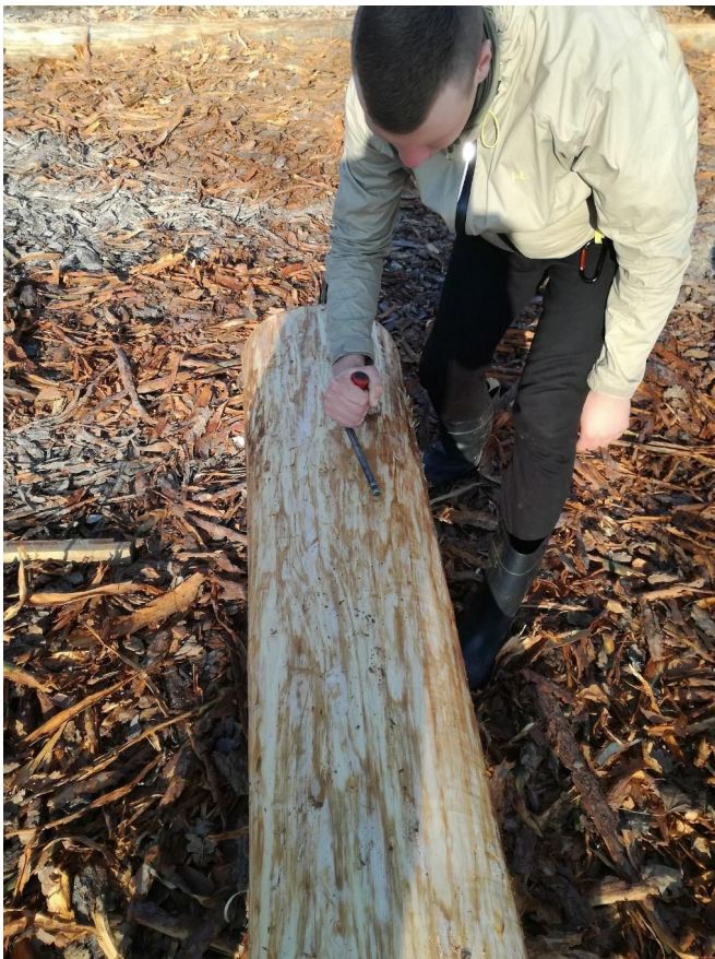
Joonis 9. Mõõdistusjoone märkimine kooritud palgile (foto: erakogu).
