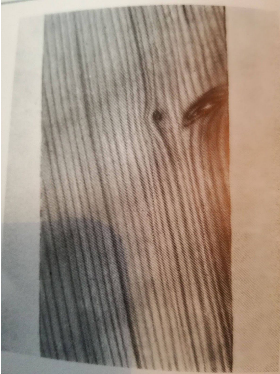
Joonis 5. Radiaalne kaldkiulisus kuuselaual (foto: erakogu).
