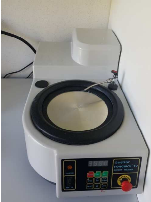
Joonis 9. Lihvmasin Metkon Forcipol V1 ( https://www.metkon.com/ ).
